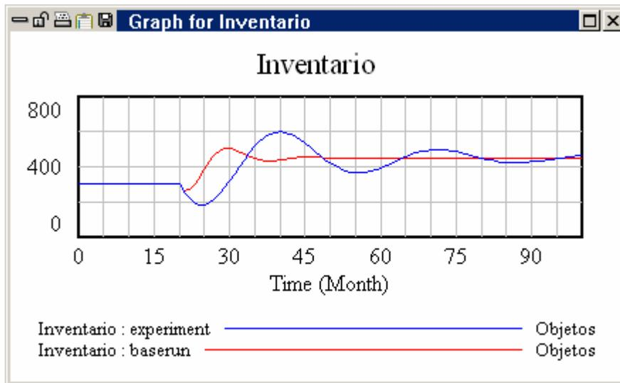
Aquí vemos los resultados de dos experimentos: *el baserun* con el valor original (3) para la variable *tiempo para ajustar la mano de obra* y *experiment* con el valor modificado (12) para el *tiempo para ajustar la mano de obra*. Los resultados muestran que tener prácticas de contratación y despidos más lentos aumenta el tamaño de la oscilación y hace que las oscilaciones duren más tiempo.
