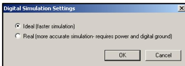
Fig. 33 Opciones para la simulación de circuitos digitales
